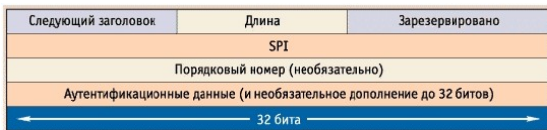
Рисунок 2.4 – Формат заголовка АН
