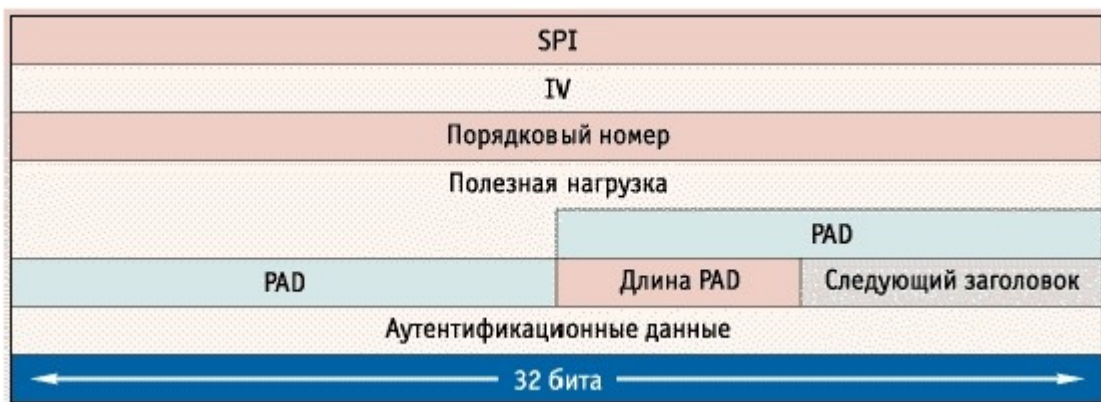
Рисунок 2.5 – Формат заголовка ESP
